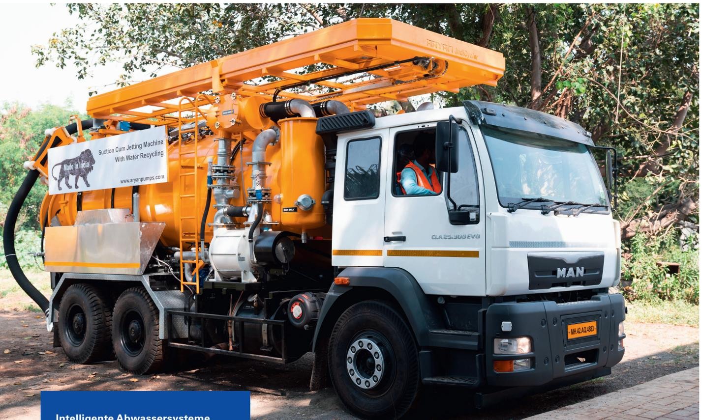
Intelligente Abwassersysteme werden von Kommunalfahrzeugen wie dem IndiCycler von Aryan gereinigt und gewartet. Das Fahrzeug recycelt abgesaugtes Abwasser und verwendet es für die nachfolgende Reinigung per Wasserstrahl.
