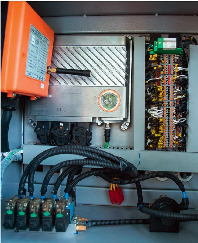
Die robuste X90-Steuerung von B&R wird direkt am Fahrzeug montiert und über die Fahrzeugbatterie mit Strom versorgt.
